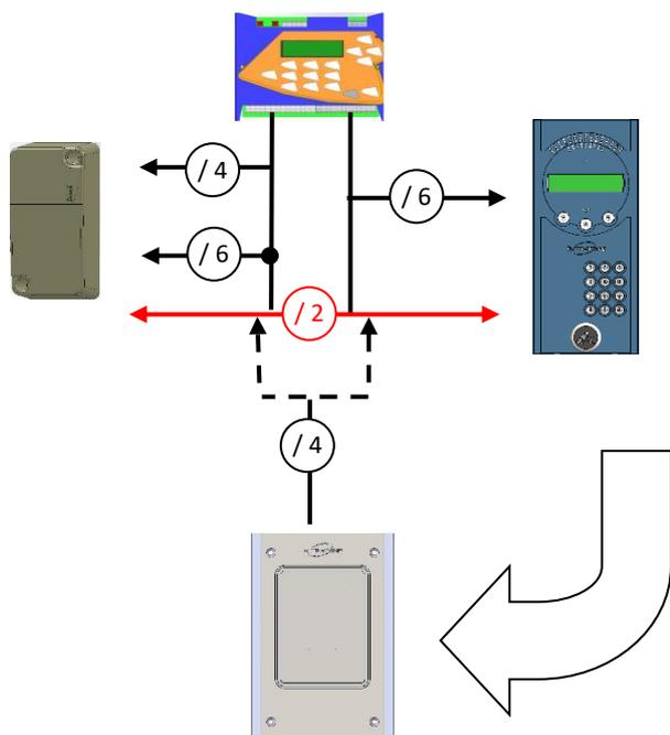
On utilise la platine pour déclencher une ouverture déportée du coffre à clés
